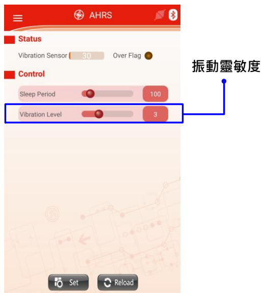
Figure 5-4 居家安全振動模組設定示意圖
