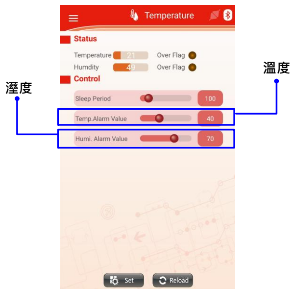
Figure 5-10 廚房安全溫溼度模組設定示意圖
