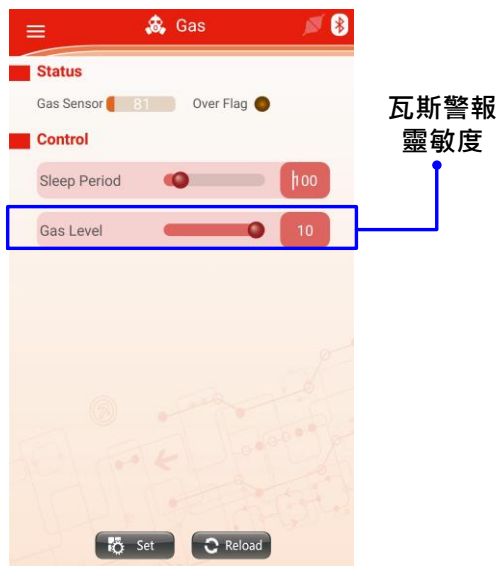
Figure 5-11 廚房安全瓦斯感測模組設定示意圖
